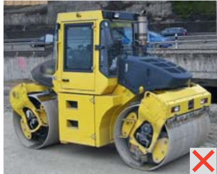
Bild 1 Walze mit Partikelfilter-Aufbau. Die Sicht des Maschinenführers ist eingeschränkt.
