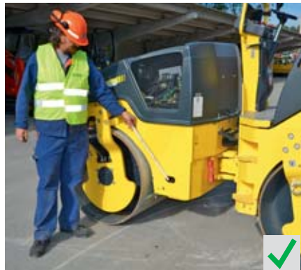
Bild 2 Walze mit eingebautem Partikelfilter. Die Sicht des Maschinenführers wird nicht beeinträchtigt.
