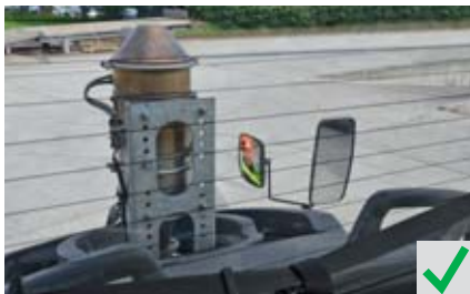
Bild 5 Kein toter Winkel dank Zusatzspiegeln.
