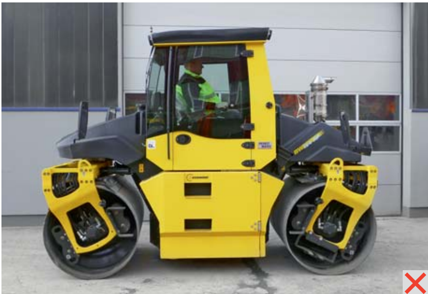
Bild 3 Walze mit drehbarem Fahrersitz. Der hinten an der Maschine angebrachte Partikelfilter-Aufbau beeinträchtigt beim Rückwärtsfahren die Sicht in Fahrtrichtung.
