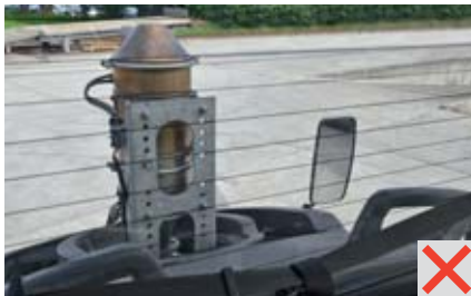
Bild 4 Toter Winkel wegen eines Partikelfilter-Aufbaus.
